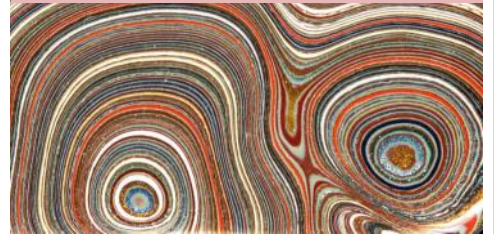
Actual paint cross section
